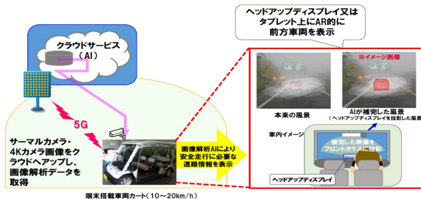
図10 5Gを活用した濃霧の中での運転補助に関する実証試験
