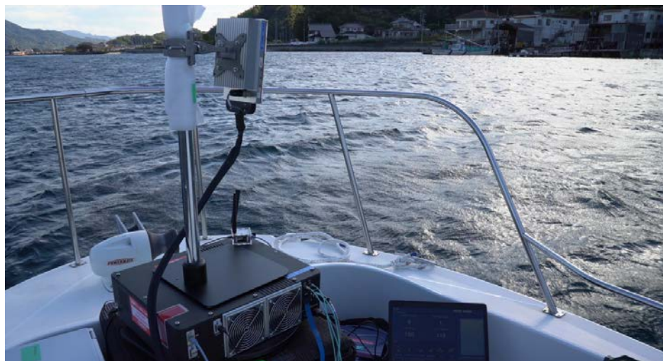
図3. 船舶のデッキ上の5G 移動局
