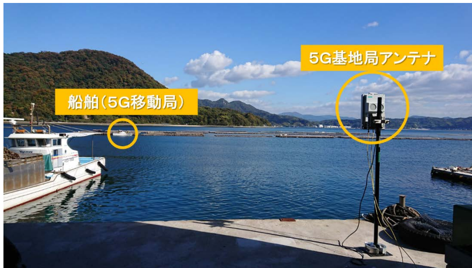
図2. やながわ水産の陸地に設置した5G 基地局と、船舶に搭載した5G 移動局
