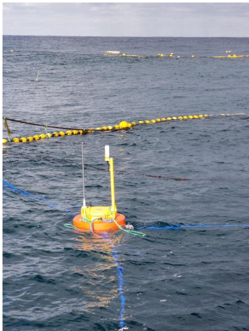
中継機ブイ (中継機を搭載したブイ)
