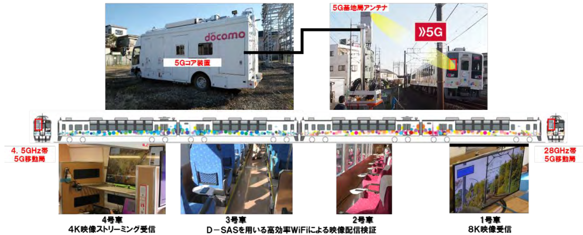
図13 東武スカイツリーラインでの高速移動体に対する5Gを介した映像伝送実証試験
