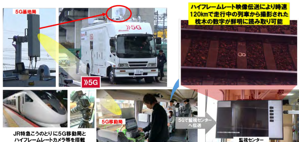
図14 5Gを活用したハイフレームレートカメラによる線路設備異常検知の実現
