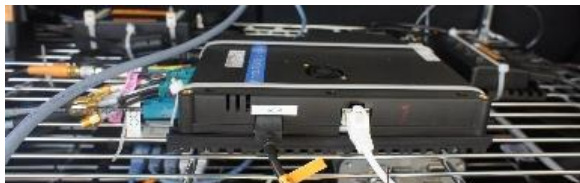
PC5用車載器 Qualcomm C-V2X DP (Development Platform) MDM9150 商用前サンプルチップ
