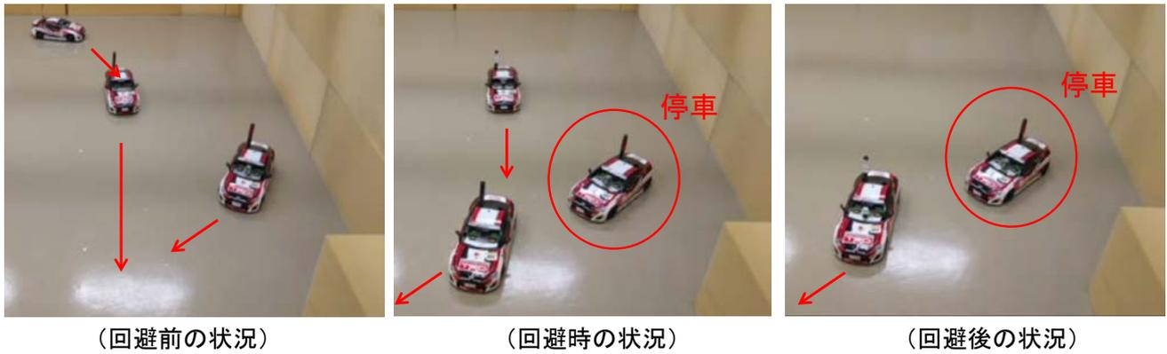
図3. 実際の衝突回避時の連続写真
