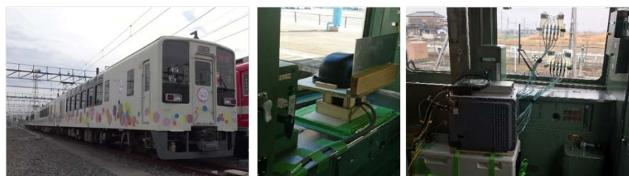
634型スカイツリートレインに搭載した5G移動局
