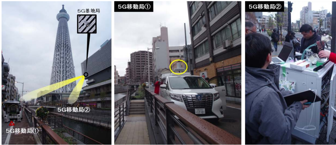
図1-1-4 5Gトリアルサイトにおける無線伝送試験
