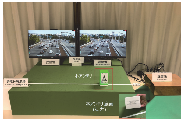
写真6 「置くだけアンテナ」によるカバレッジ拡張デモ
