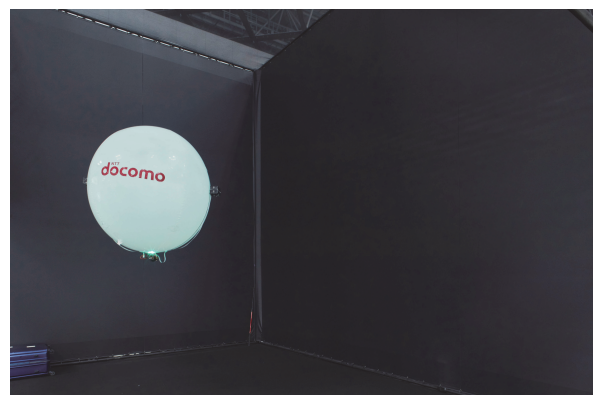
写真7 発光しながら飛行する羽根のないドローン
