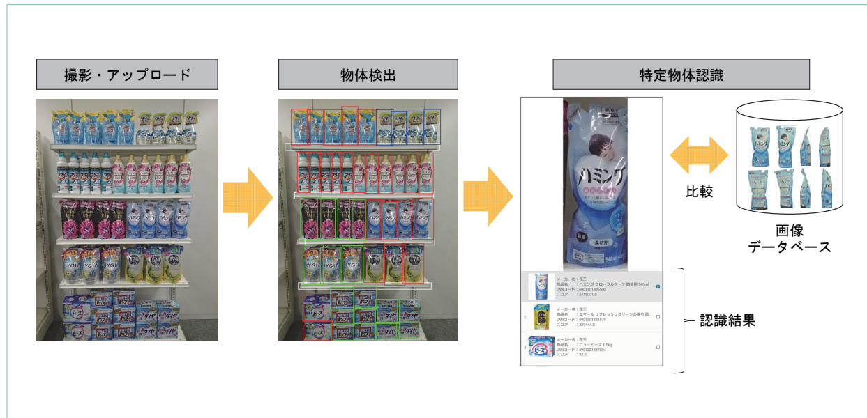
図1 商品棚画像認識処理フロー
