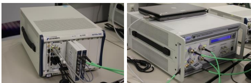
左上:送受信装置 右上:チャンネルエミュレータ 右下:信号波形検証画面
