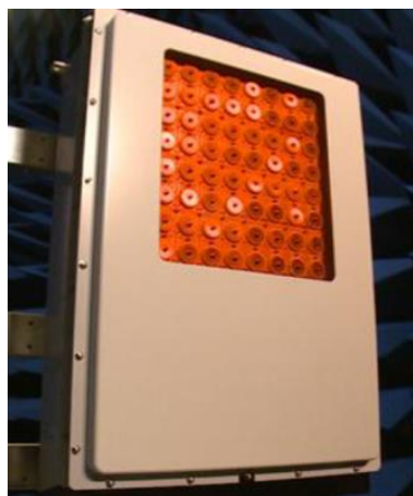
左:128素子AAS(Active Antenna System) 中:交差偏波に対応したアンテナ素子(拡大) 右:4つのマルチ直交ビームパターン(最大8ビームまで)
