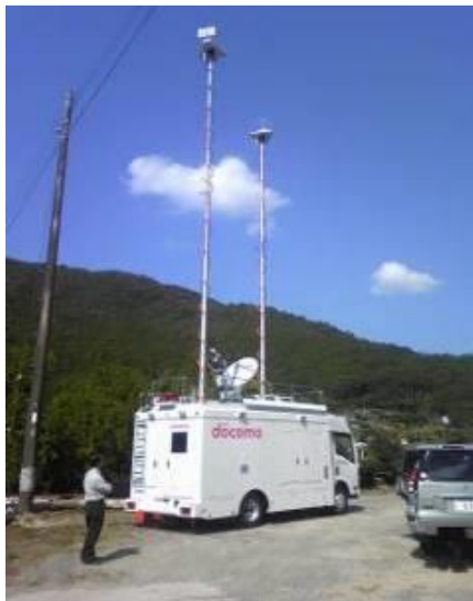
衛星エントランス搭載 移動基地局車
