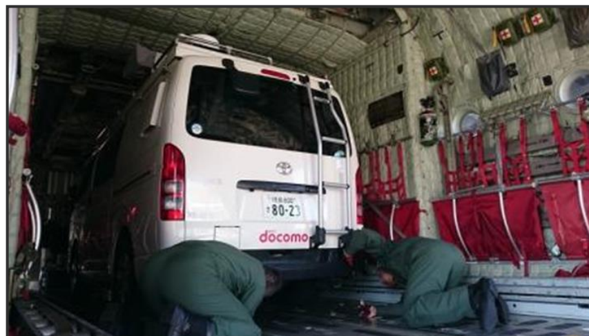
機内の車両固定確認
