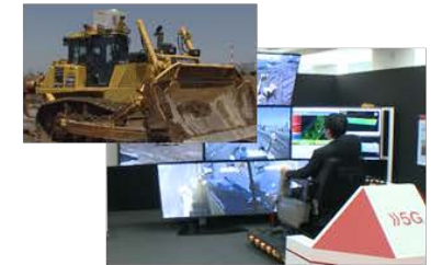
建設機械等の遠隔操作
