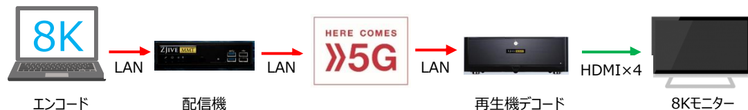
■5G×8K映像伝送 実証実験構成図
