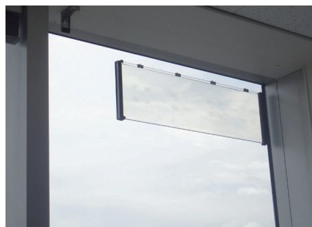
ガラスアンテナを既存窓に貼付した様子
