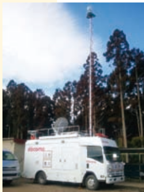
衛星回線による設備復旧
