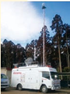
衛星回線による設備復旧
