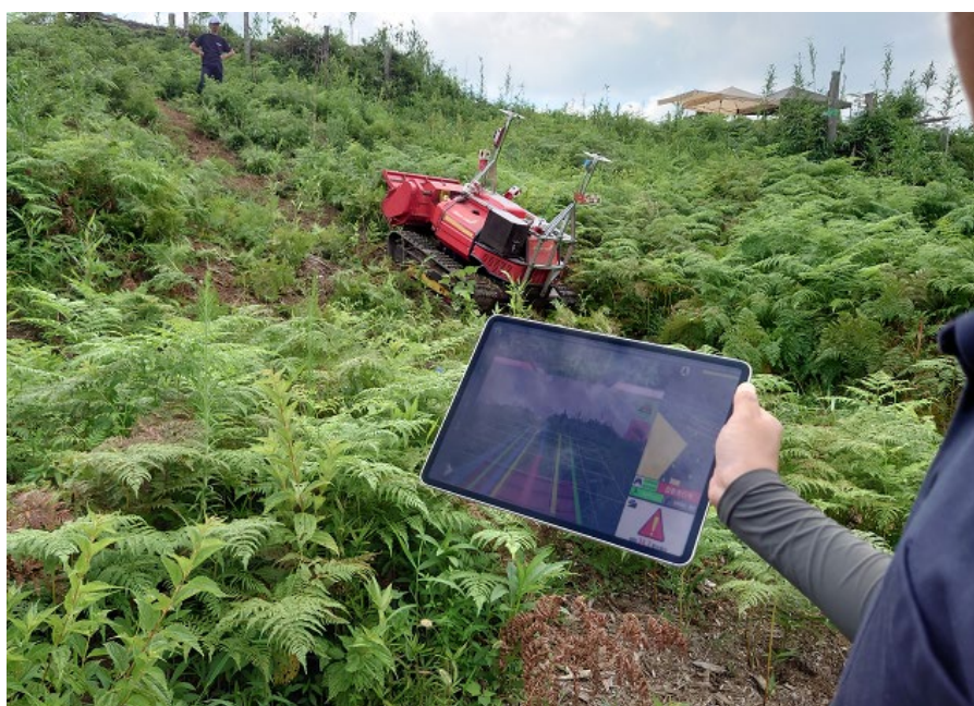
傾斜約 25 度を登坂している自動運転型下刈機械
