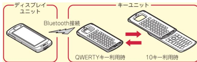
FOMA端末をディスプレイユニットとキーユニットに分離し(⇒P20)、Bluetooth通信によるキーユニットからの操作やディスプレイユニットだけで使用するスタイルです。キーユニットで通話しながら、ディスプレイユニットでワンセグ視聴やメールの送受信、サイト閲覧などができます。キーユニットを閉じた状態では、QWERTYキーによるローマ字入力やゲームモードでのiアプリ操作ができます。
