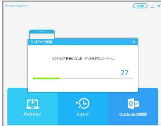
ダウンロードが完了すると、本端末のアップグレードが自動的に開始されます。
