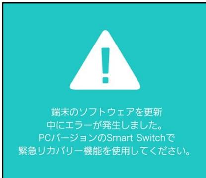
※ 上記の操作以外に、本端末の側面の音量キーの「小」を押しながら側面の電源／画面ロックキーを押して本端末を再起動させることもできます。その場合は以下のようないい画面が表示されることを確認してから、本端末の側面の音量キーの「大」を押してください。
