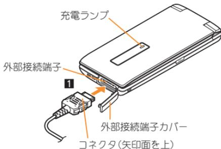
**2** ACアダプタの電源プラグをコンセントに差し込むと、充電確認音が鳴り、充電ランプが点灯して、充電が開始する
