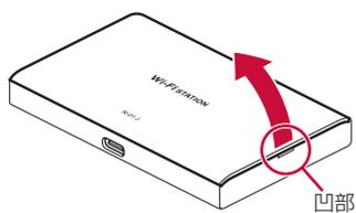
2 電池パックの赤丸部分を矢印方向 (①) に持ち上げて、矢印方向 (②) に引き出して取り外す
