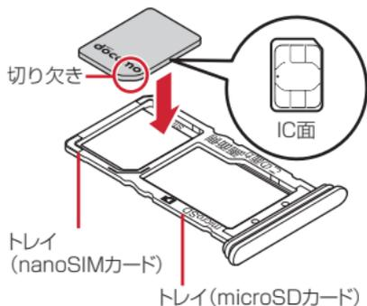
④ 本端末のディスプレイ側が上に向いていることを確認して、スロットキャップを矢印の方向にまっすぐ水平に差し込む
