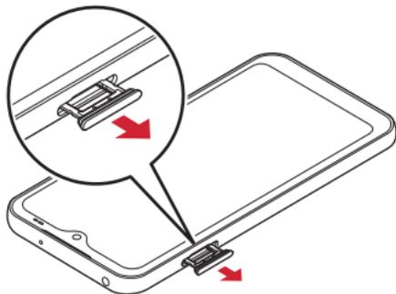
③ nanoSIMカードのIC面を下にして、スロットキャップのトレイ (nanoSIMカード) にはめ込む
