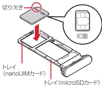
④ 本端末のディスプレイ側が下に向いていることを確認して、スロットキャップを矢印の方向にまっすぐ水平に差し込む
