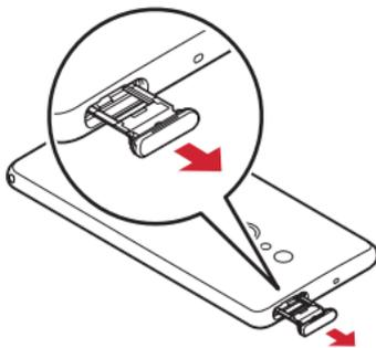
③ nanoUIMカードのIC面を下にして、スロットキャップのトレイ (nanoUIMカード) にはめ込む
