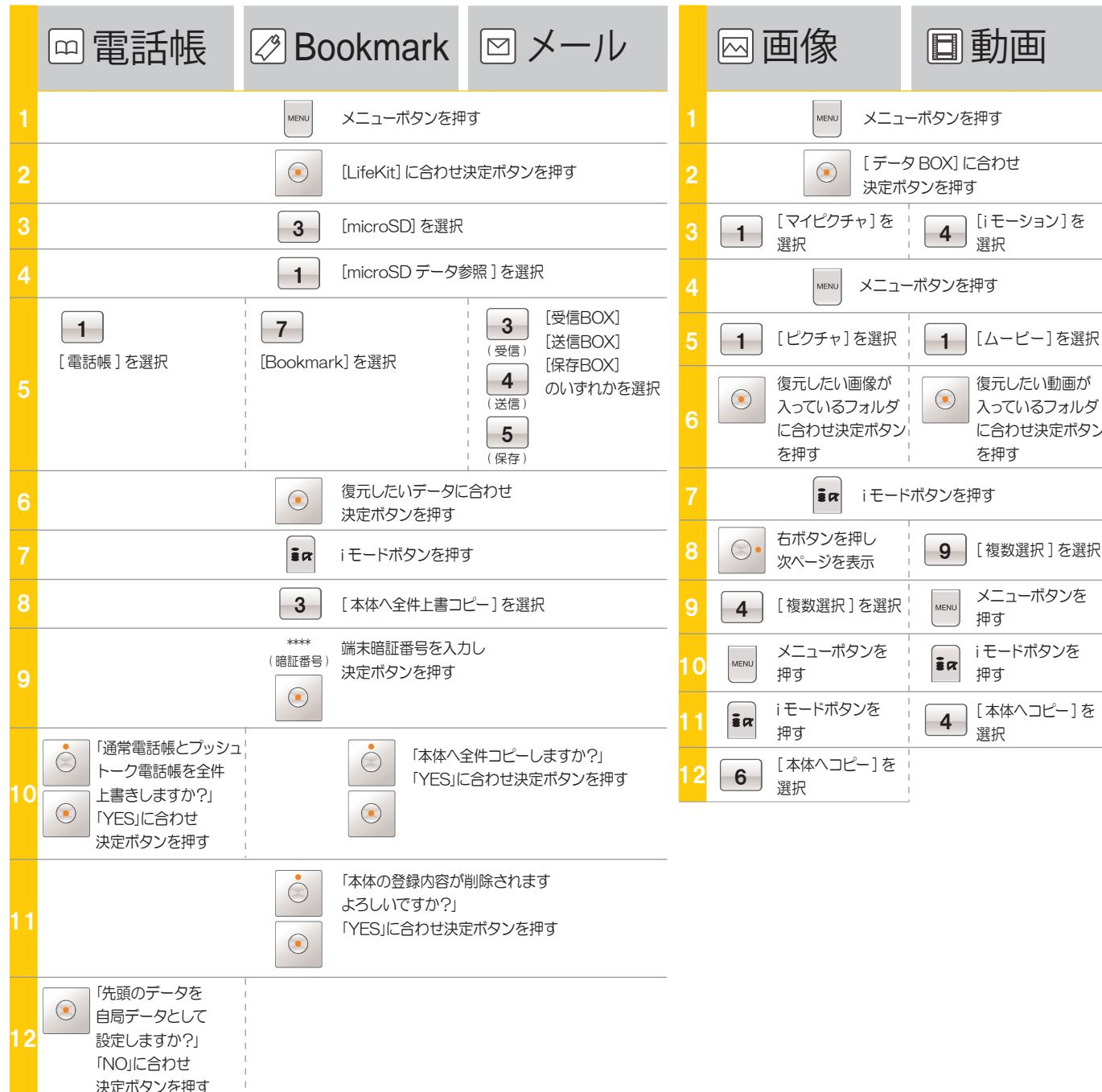
**重要** ■復元作業を行うと、FOMA端末に保存されていた元のデータ(保護・シークレット設定されたデータ含む)はすべて消去されます。必要なデータが入っている場合は事前にバックアップしてください。
