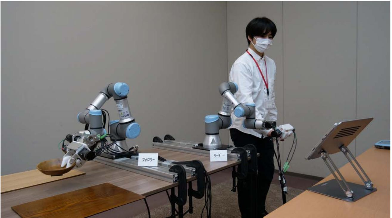
遠隔操作で食器の運搬動作をロボットに覚えさせている様子
