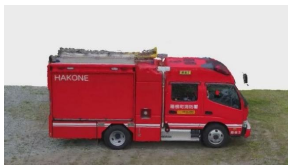
<撮影した写真より作成した消防車の 3D モデル>
