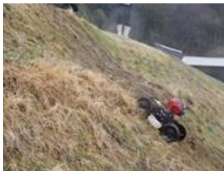
<実証で使用する草刈機が畦畔の斜面を走行、草刈りをする様子>
