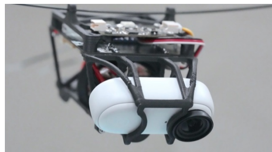
制御回路およびアクションカメラ(機体下部)
