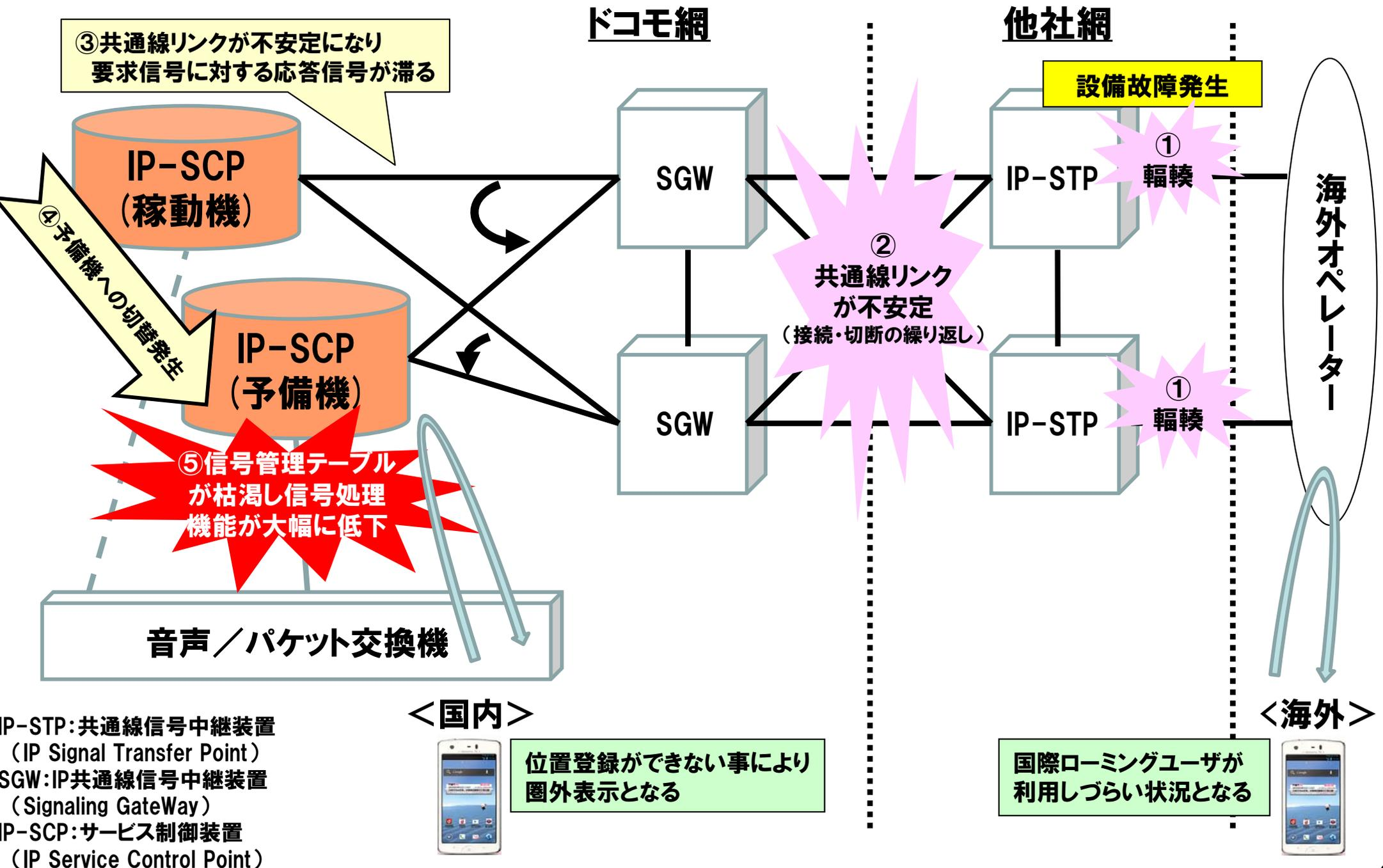
IP-STP: 共通線信号中継装置 (IP Signal Transfer Point)
