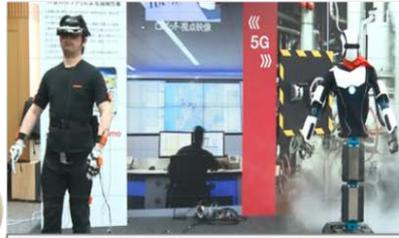
ロボットの遠隔操作
