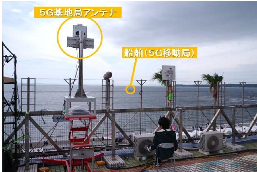
図2. ホテル屋上に設置した5G基地局と、船舶に搭載した5G移動局
