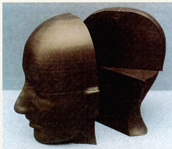
図10 人体頭部固形ファントムモデル Figure 10 Life Size Humann Head Dry-Phantom Model.
