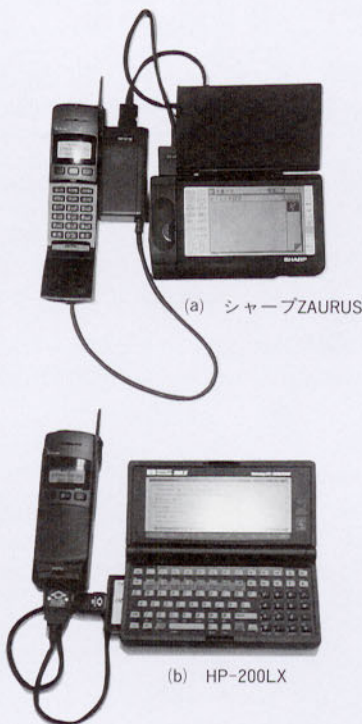
図7 デジタルmovaと携帯情報端末の組合せ例 Figure 7 Combination of Digital mova and Portable Information Terminal
