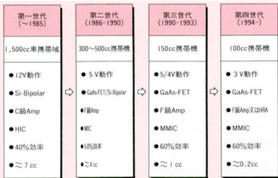
図11 送信電力増幅器の技術的進展
