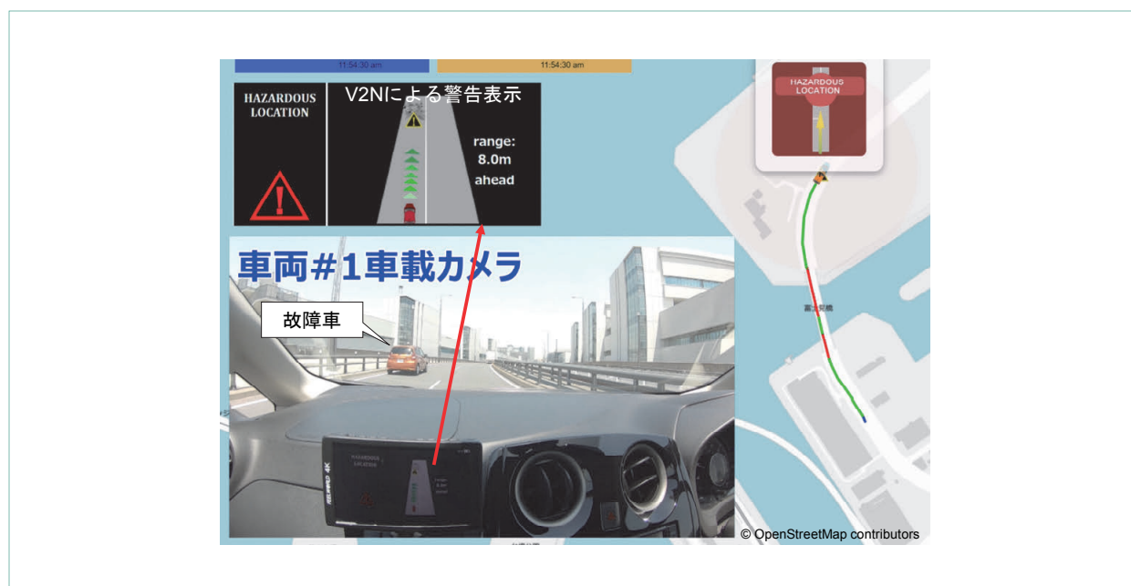
図5 V2Nによる故障車通知
