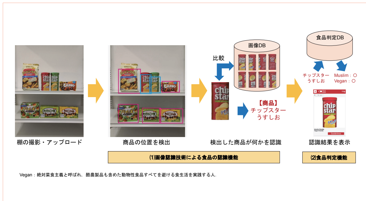
図1 食品判定システムの認識フロー
