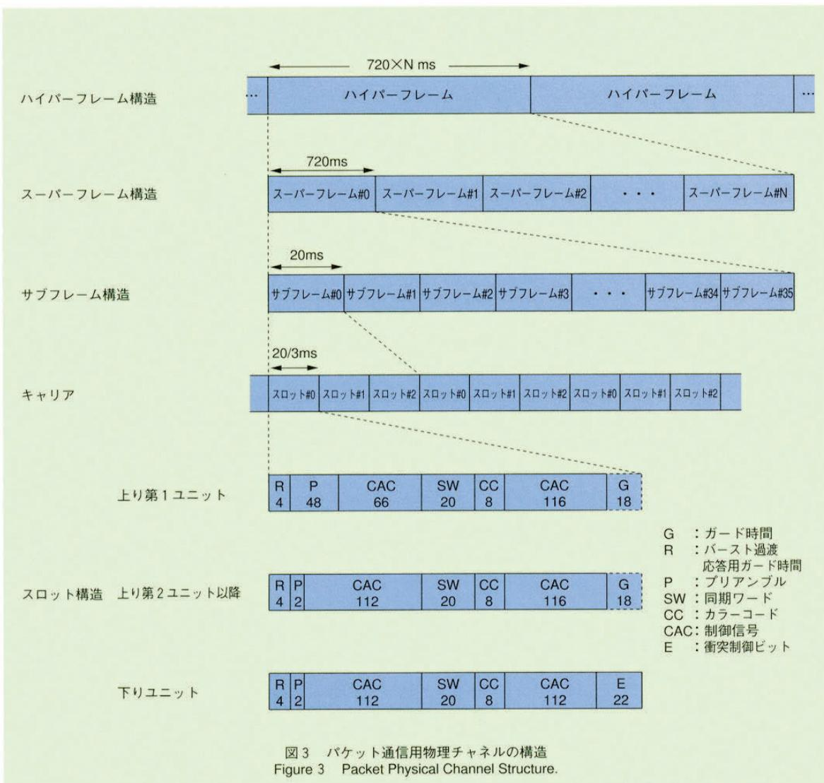
図3 パケット通信用物理チャネルの構造
