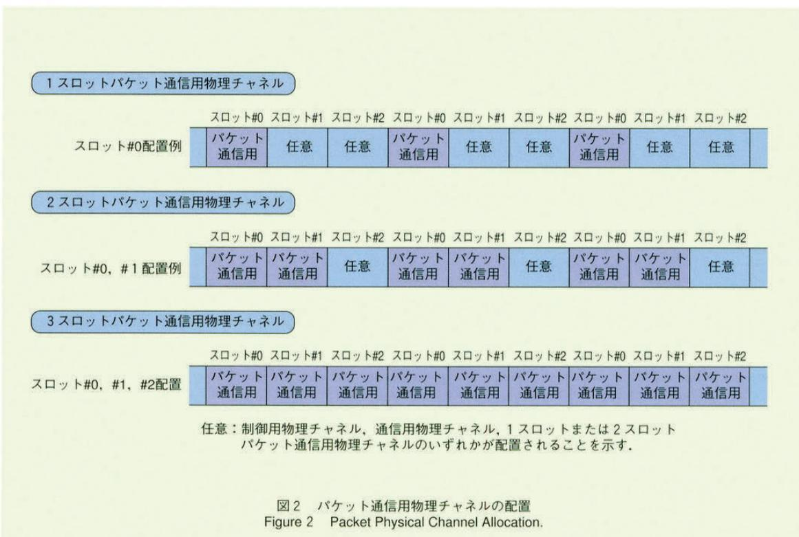
図2 パケット通信用物理チャンネルの配置
