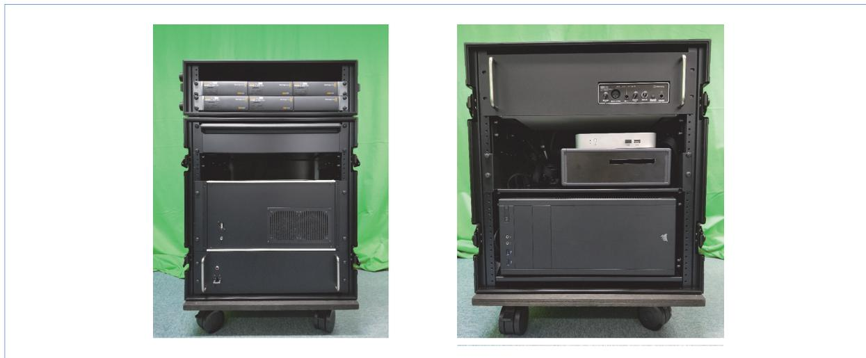
図3 スティッチング装置 (左), エンコーダ装置 (右)
