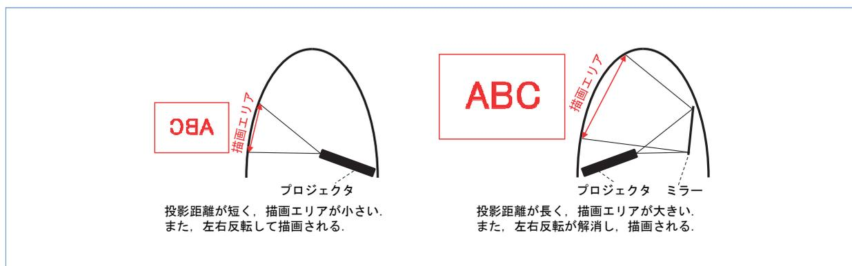
図6 ミラーを利用した描画エリアの拡大と裏面への光の透過
