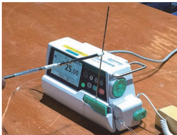
写真1 輸液ポンプのEMI耐性評価の様子
