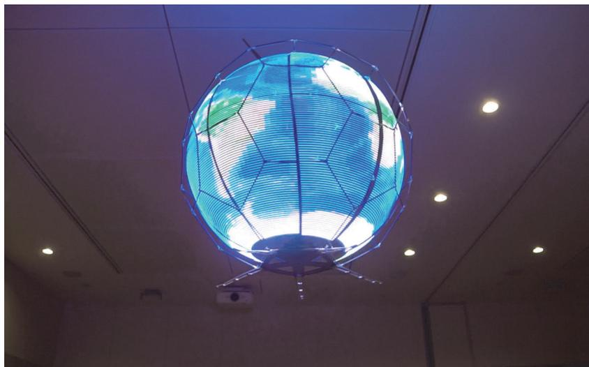
図1(a) 飛行中の浮遊球体ドローンディスプレイの様子
