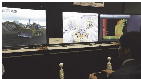
建設機械遠隔操作システム
