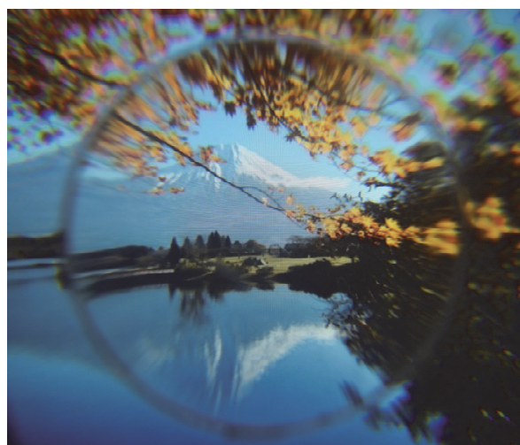
(a)凸レンズとフレネルレンズの両方を備えたプロトタイプ
