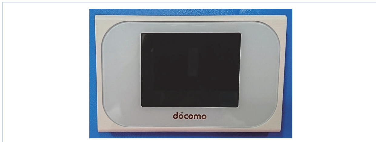
写真1 4×4 MIMO対応移動端末の外観
