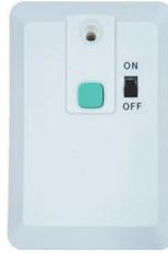
5～6秒間息を吹きかけるだけで、脂肪代謝の指標となる「アセトン」と、飲酒の指標となる「エタノール」の濃度を同時に計測可能な呼気計測装置を実装
