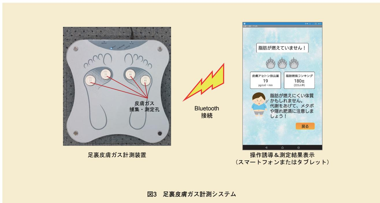
図3 足裏皮膚ガス計測システム
