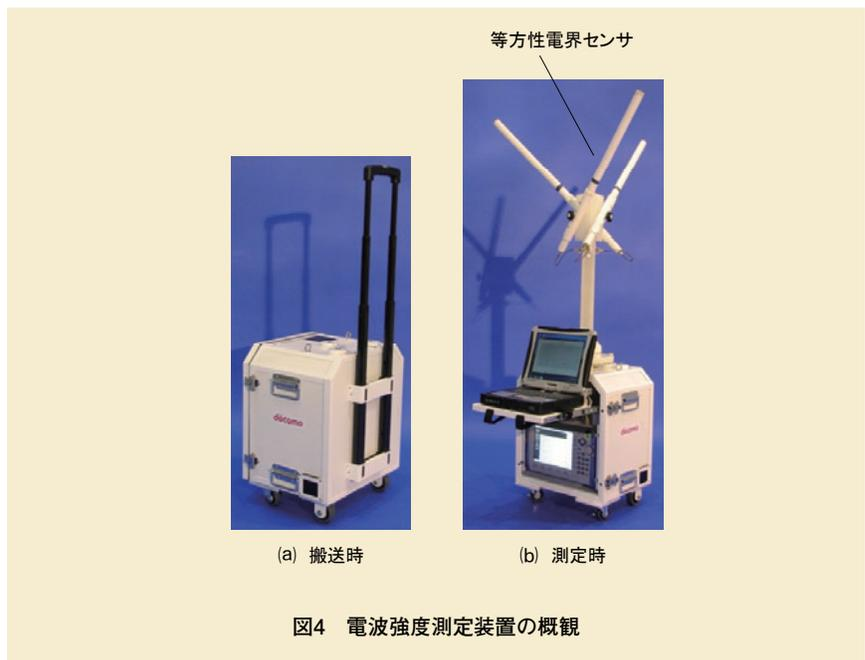
図4 電波強度測定装置の概観
