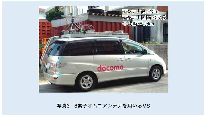
写真3 8素子オムニアンテナを用いるMS
