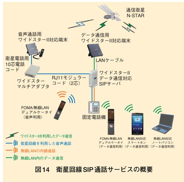
図14 衛星回線SIP通話サービスの概要
