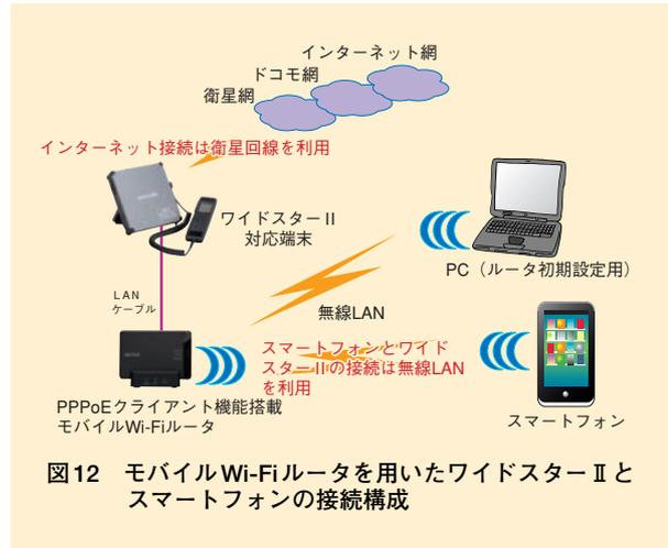
図12 モバイルWi-Fiルータを用いたワイドスターIIとスマートフォンの接続構成
