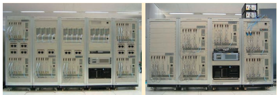
写真1 MIMO 送受信実験装置外観
