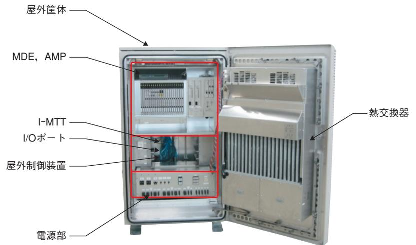
図2 2キャリア1セクタBTSのオールインワン構成
